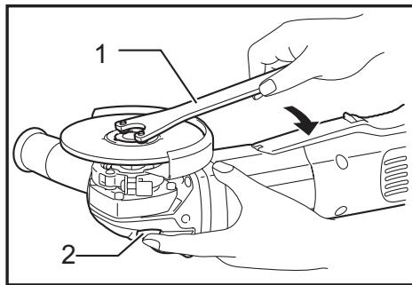
► 1. Clé à contre-écrou 2. Verrouillage de l'arbre
