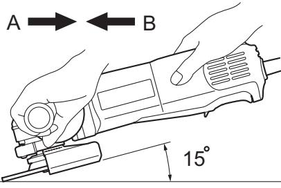
TOUJOURS tenir l'outil fermement avec une main posée sur le blindage et l'autre retenant le manche latéral. Mettre l'outil en marche et appliquer la roue de meulage ou le disque sur la pièce d'usinage.
