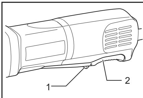
► 1. Palanca de desbloqueo 2. Palanca interruptora
