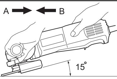
Sujete SIEMPRE la herramienta firmemente con una mano en la carcasa y la otra en la empuñadura lateral. Encienda la herramienta y después aplique el disco a la pieza de trabajo.
